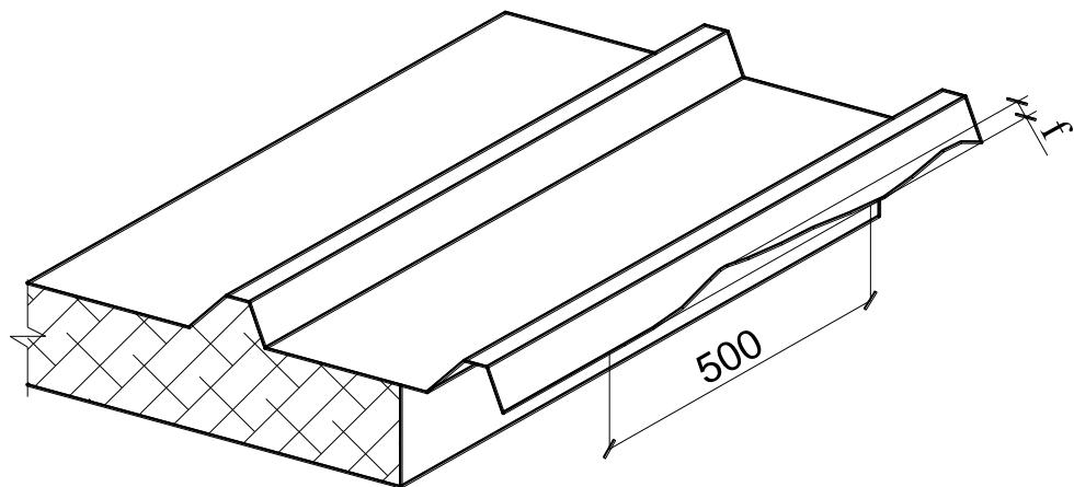
Рисунок 17 – Схема измерения отклонения кромки свободного гофра стыка
