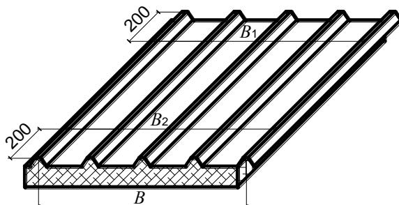
а) Схема измерения рабочей ширины кровельной панели
