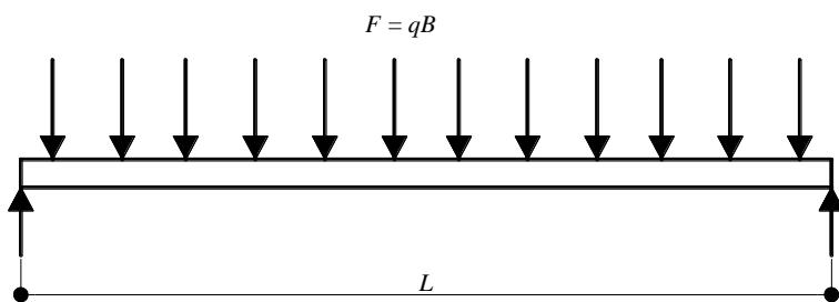
Рисунок Б.3 – Воздействие воздушного давления или вакуума
