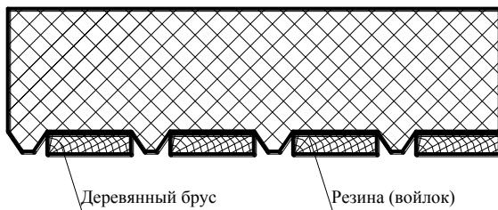
Рисунок Б.5 – Схема деревянных прокладок
