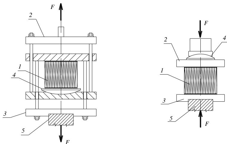
а) Схема нагружения образца
