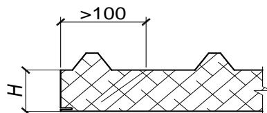
Рисунок 10 – Схема измерения толщины панели
