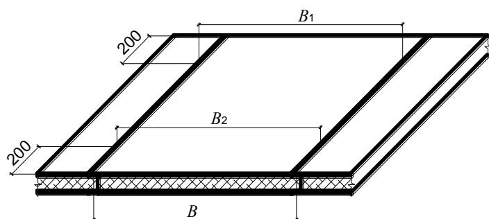
б) Схема измерения рабочей ширины стеновой панели
