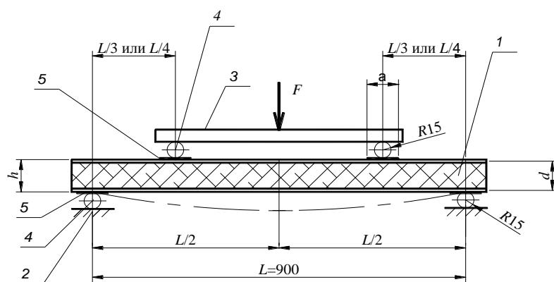
1 – испытываемый образец; 2 – опорная поверхность; 3 – распределительная балка; 4 – стальные цилиндрические опоры,  $R = 15$  мм; 5 – прокладки, одна из которых стальная сечением  $5 \times 60 \times b$  мм, а другая – деревянная или фанерная сечением  $15 \times 60 \times b$  мм
