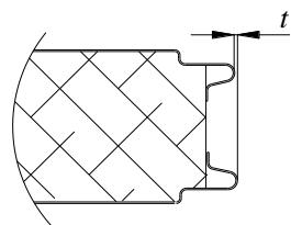
Рисунок 15 – Схема измерения смещения продольных кромок
