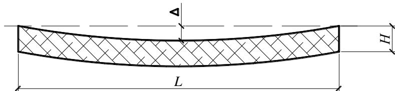
Рисунок 14 – Схема измерения прогиба панели
