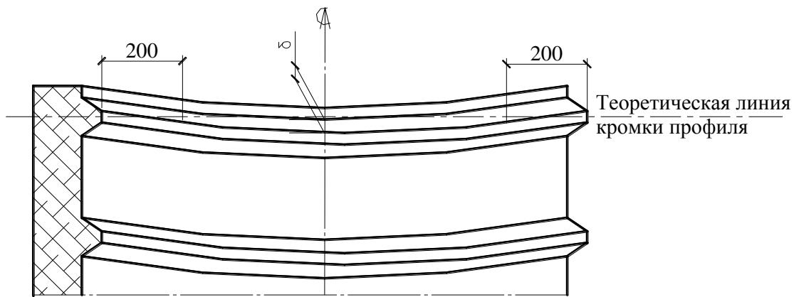
Рисунок 13 – Схема измерения серповидности
