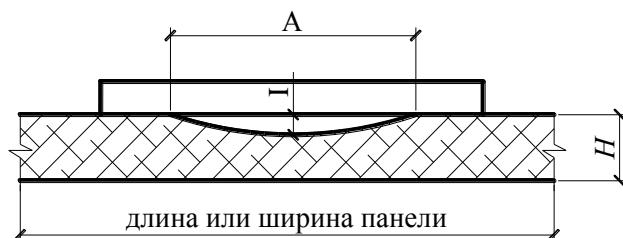
Рисунок 16 – Схема измерения отклонения от плоскостности
